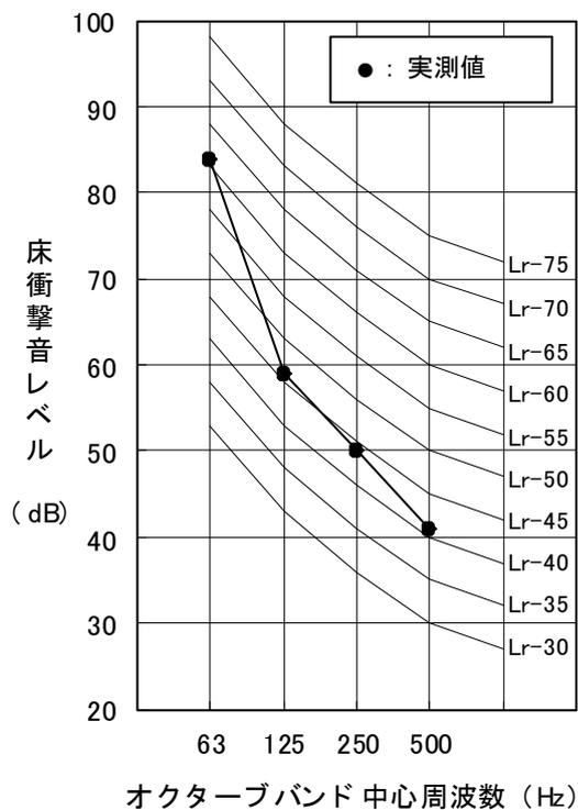
図-13 建物物件（4）の重量床衝撃音レベル実測値
