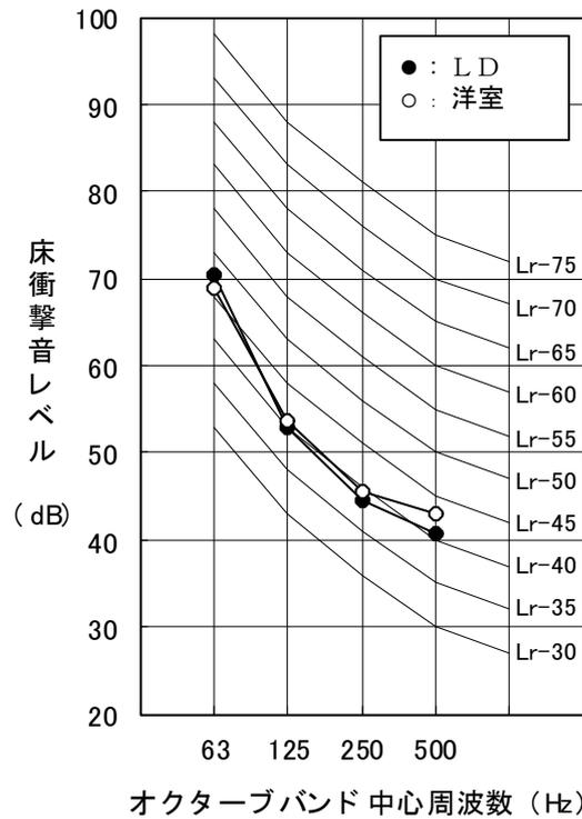
図-15 建物物件（2）の重量床衝撃音レベル実測値
