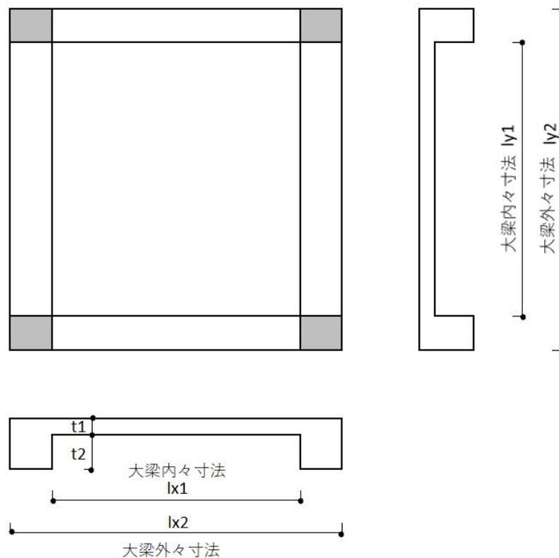
図-17 純ラーメン構造の固有振動数算出モデル
