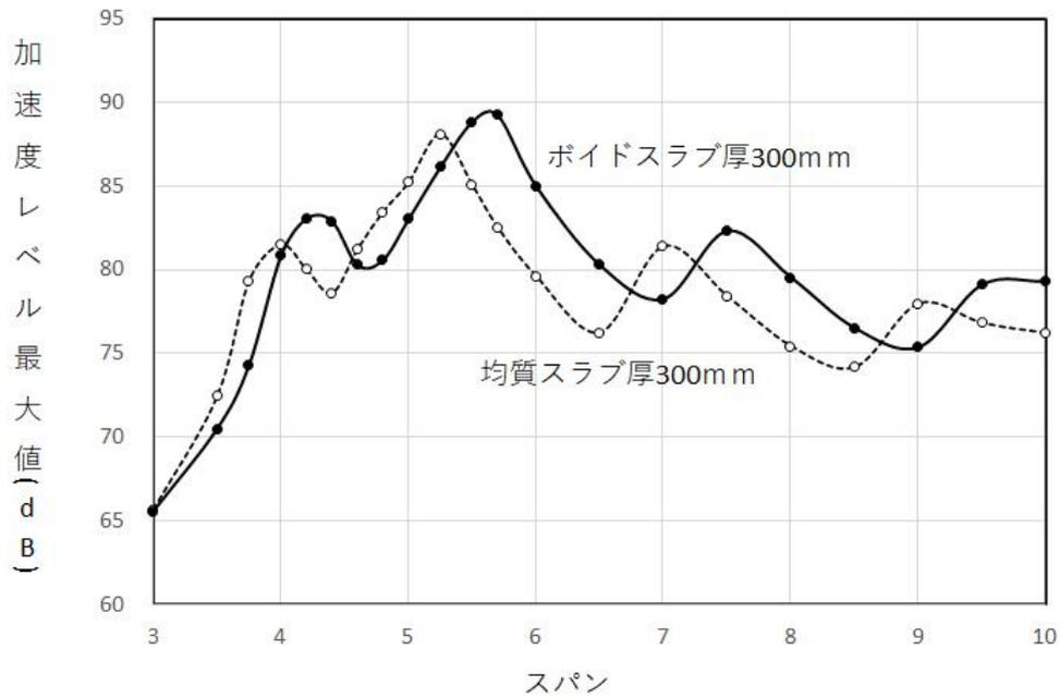
図-4 ボイドスラブ・厚 300mm (No. 6) のスパン変化による解析結果
