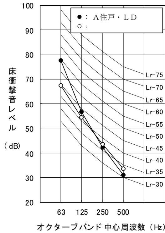
図-16 建物物件（5）の重量床衝撃音レベル実測値
