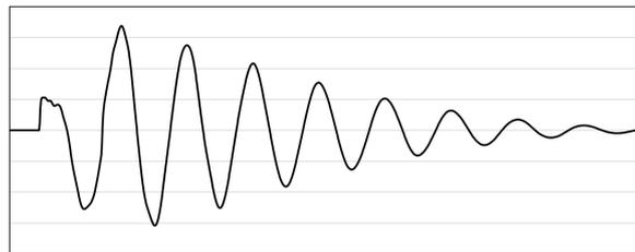
図-9 正弦半波加振時の減衰波形の例
