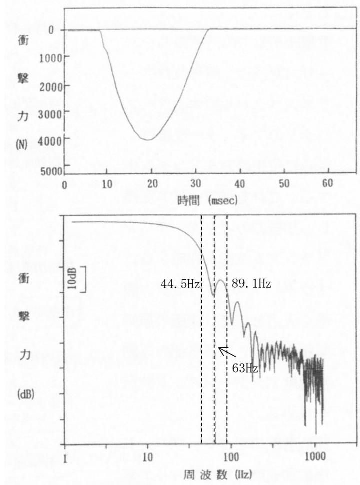
図-10 重量衝撃力のスペクトル特性（実測値）
