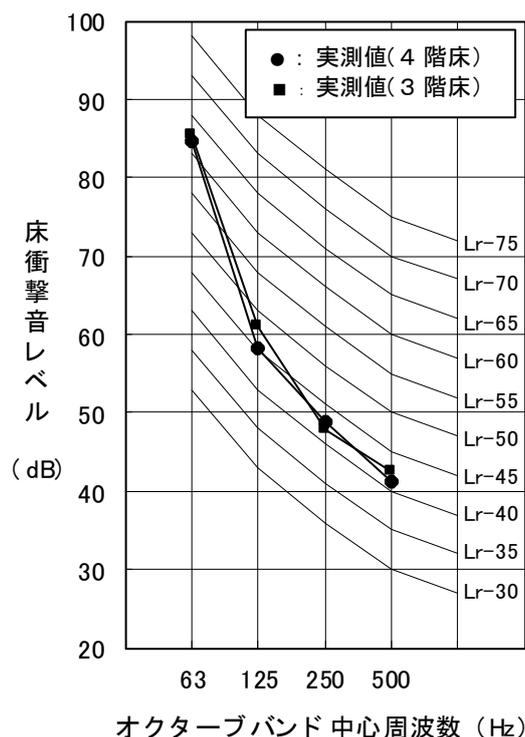
図-11 建物物件（1）（A住戸・洋室）の重量床衝撃音レベル実測値
