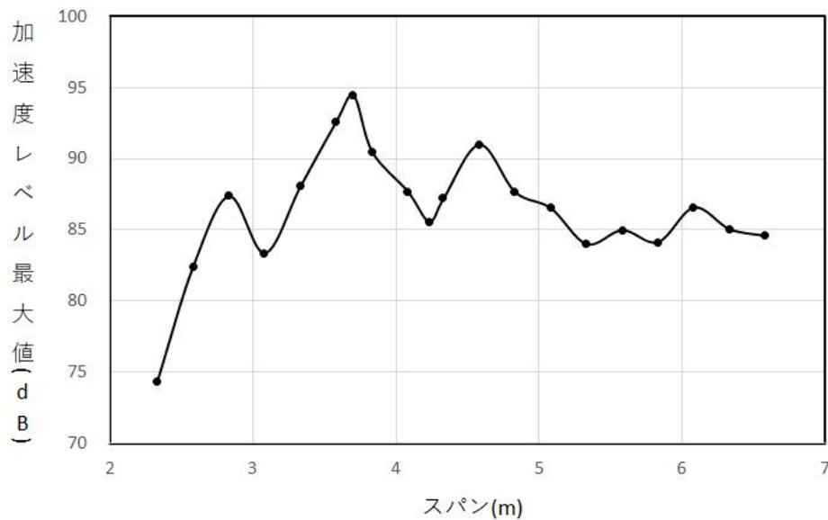
図-5 長方形スラブ・厚 200mm (No. 2) のスパン変化による解析結果
